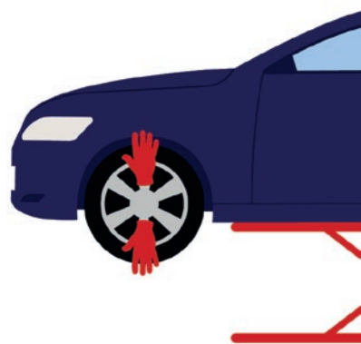
Sprawdzanie luzów na łożyskach kół
