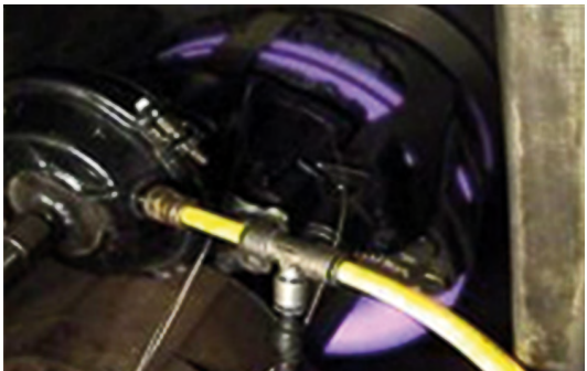
Hamulce podczas intensywnego hamowania osiągnęły temperaturę 500 – 600 C
