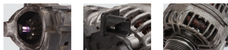
fioletowy nalot na osi, ślady przegrzania
