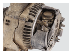
uszkodzona plastikowa ostona
