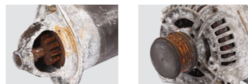
znacząca korozja zębnika lub obudowy
