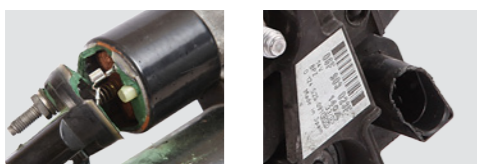
uszkodzenie plastikowej części przełącznika złączającego
