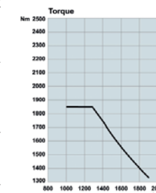
Silnik 6 cylindrowy, rzędowy, 13 l, moc maks. 360 KM, maks. moment obr. – 1850 Nm
