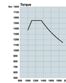
Silnik 5 cylindrowy, rzędowy, 9 l, moc maks. 310 KM, maks. moment obr. – 1550 Nm
