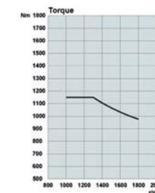
Silnik 5 cylindrowy, rzędowy, 9 l, moc maks. 250 KM, maks. moment obrotowy – 1150 Nm
