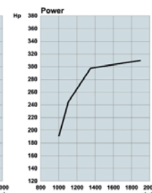
Silnik 5 cylindrowy, rzędowy, 9 l, moc maks. 310 KM, maks. moment obr. – 1550 Nm
