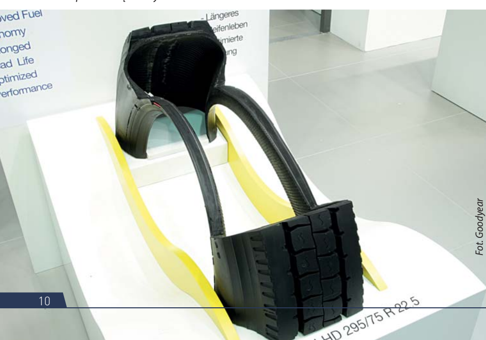
Prototypowy system samoczynnego utrzymywania ciśnienia powietrza w oponie bez użycia kompresora, elektronicznego sterowania lub innych urządzeń opracowany przez firmę Goodyear.
