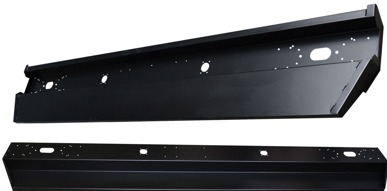
Zderzak pasujący do naczepy marki Shmitz, malowany proszkowo na kolor czarny o długości 2,4m i szerokości 0,4m Nr Vanstar: 107057R
