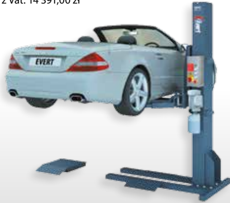
Podnośnik 1-kolumnowy EVERT612FE elektrohydrauliczny 612FE, udźwąg: 2500kg, automatyczna blokada elektromagnetyczna, WERSJA STACJONARNA Indeks IC: EVERT612FE Cena netto: 11 700,00 zł Cena z Vat: 14 391,00 zł
