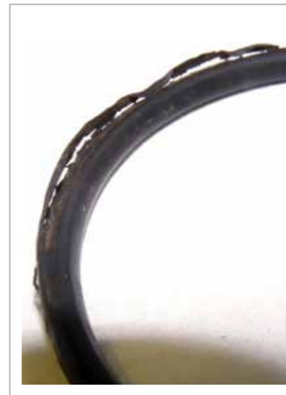
10.13 Uszkodzenia spowodowane nieprawidłową instalacją
