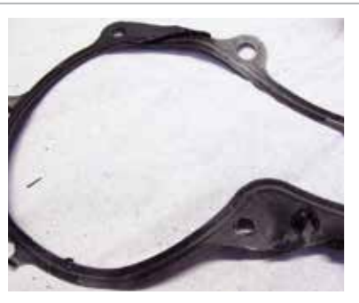
10.11 Pasta uszczelniająca niewłaściwie zastosowana do metalowej uszczelki
