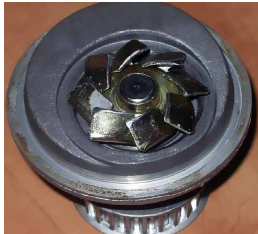
10.15 Wirnik uszkodzony przez ciało obce znajdujące się w układzie
