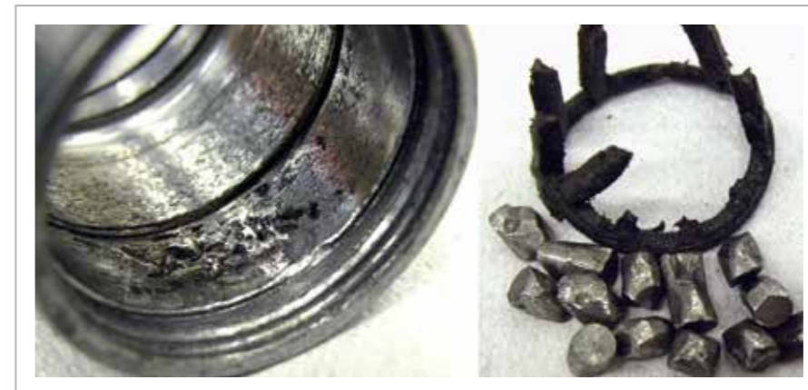
10.9 Komponenty łożyska uszkodzone przez nadmierne obciążenie
