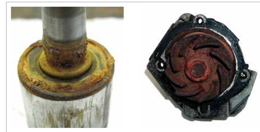
10.1 Zardzewiałe elementy spowodowane stosowaniem nieodpowiednich chłodziw
