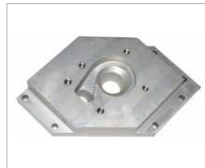
6.3 Osprzęt testowy dla pomiaru prędkości przepływu
