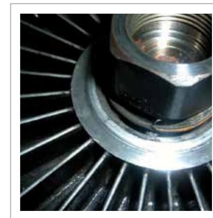
10.5 Uszkodzone sprzęgło wiskotyczne
