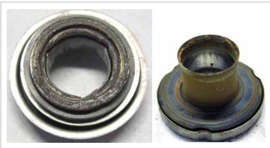
10.2 Mechaniczne uszczelki uszkodzone przez nieodpowiednie chłodziwa
