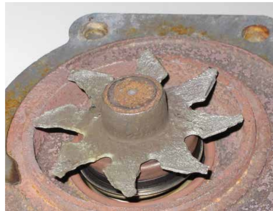
7.1 Całkowicie skorodowany wirnik z powodu niewłaściwego płynu
