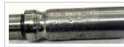
10.8 Wał łożyska uszkodzony przez nadmierne obciążenie
