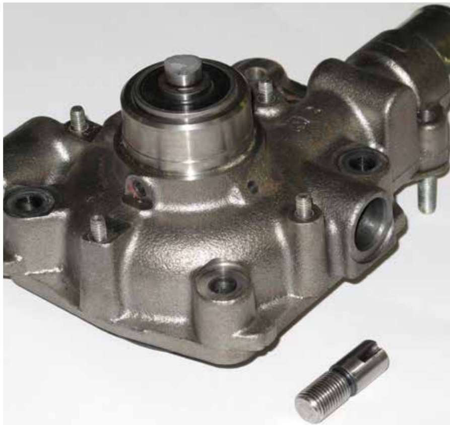
10.14 Wał łożyska uszkodzony wskutek nieprawidłowych procedur montażowych
