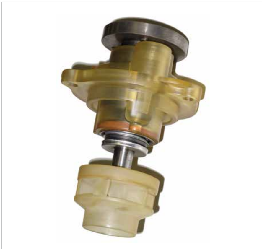
6.2 Prototyp pompy wodnej z elementami wykonanymi z żywicy
