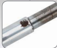
Damaged piston rod Kolbenstange beschädigt Vahingoittunut männänvarsi
