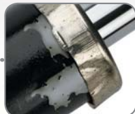
Oil leakage Starker Ölverlust Öllyvuoto
