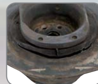
Torn strut insulator Gerissene Gummilagerung Revennyt tukilaakerin kumi
