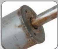
Rusted body Korrodiertes Außenrohr Ruostunut runko
