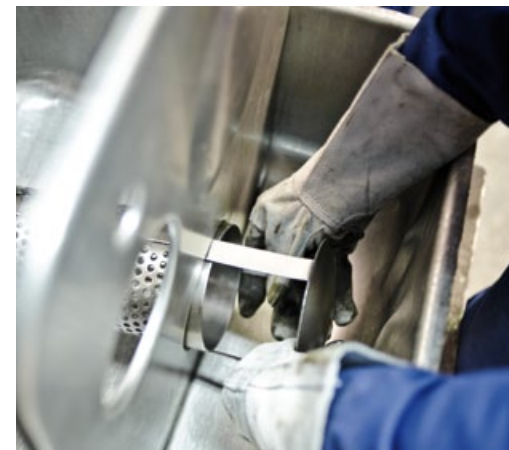
Instalacja perforowanych rur i przegród.
