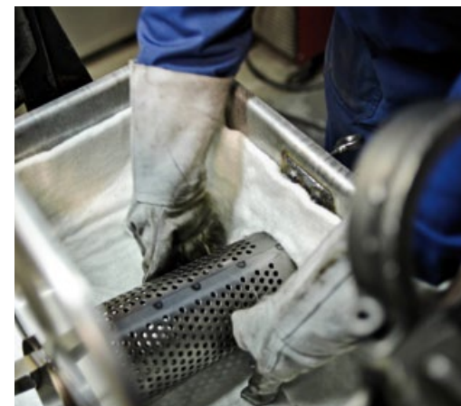
Instalacja elementów wygłuszenia denka i czaszy.
