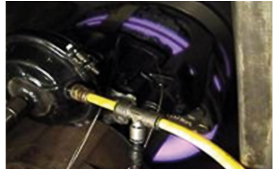
Hamulce podczas intensywnego hamowania osiągają temperaturę 500 – 600 C
